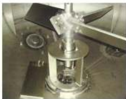
搬送装置内で破損ボルトにより外れた 搬送ブレード
