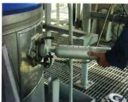
ガラスコーティング容器の検査 (ø76mm ノズルを通過)
