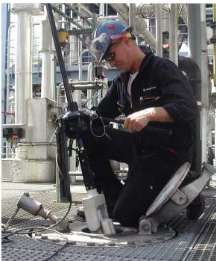
回転機軸付き三脚、延長ポールを用いた、PTZ140 システムによる 化学プラントの容器検査
