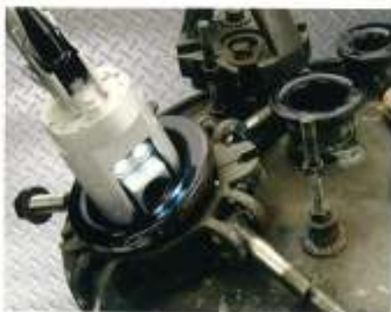
ø100mm ノズルを通し容器内部を検査
