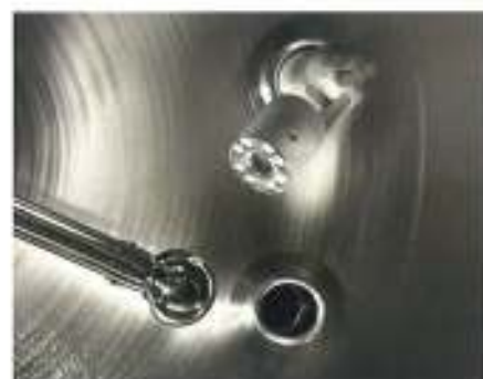
洗浄バリデーション： スプレーボールのカバー範囲の検査
