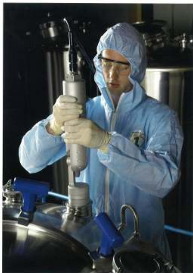
76mm ノズルを通し容器内部を検査
