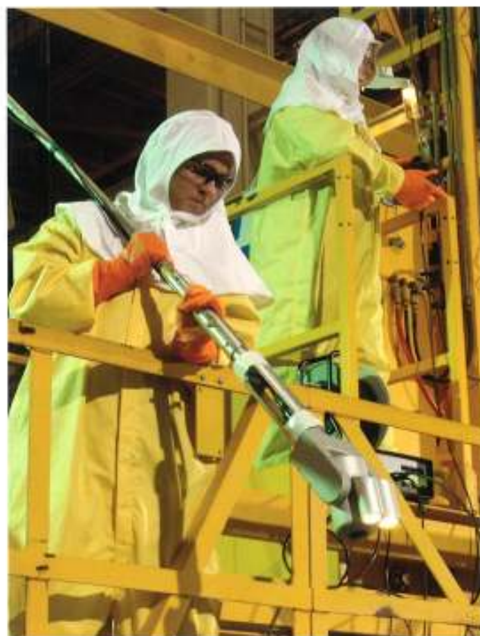
Ca-Zoom® PTZ デジタルシステムで原子炉容器を検査
