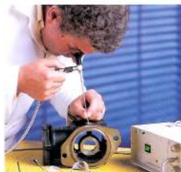
ミニリジッドスコープによるエアプレーキコンプレッサーの検査
