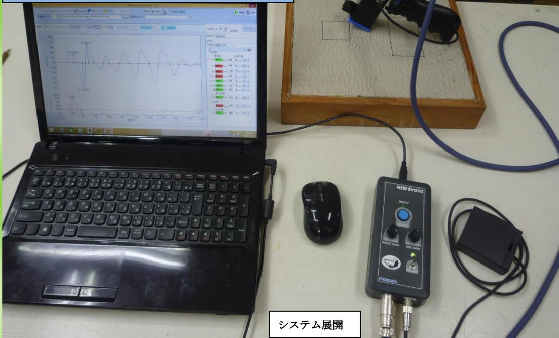
装置は打撃・集音部・計測部・電源部で構成、USB通信により、別途用意されたPCで打音波形の表示、記録、比較を行います。対象物の表面に打撃・集音部を接触させ、PC画面上の打撃タブをクリックする事で打撃・集音部に内蔵された打撃棒が対象物を打撃し打撃反射音が集音部のマイクから計測部を経由し出力波形がPC画面に表示されます。
