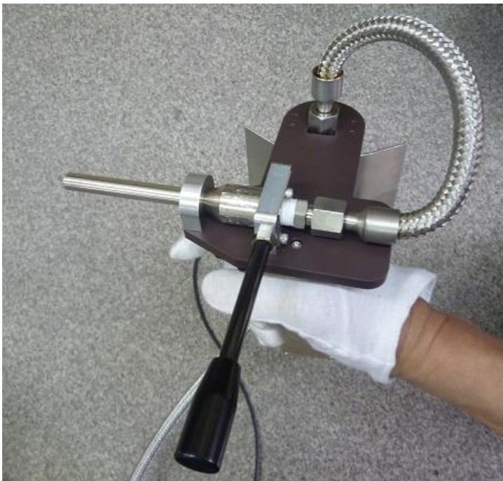
蒸気流 ON/OFF スイッチ付、100L/min 流量のマッハ・ノズルを使用。
