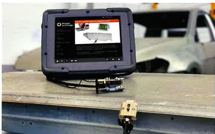
Krautkrämer Bond Scanner は、構造用接着剤で接合された部品を迅速かつ簡単に検査できます。
